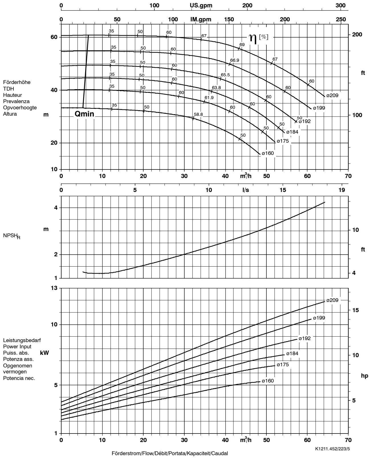
Laufradaustrittsbreite/Impeller outlet width/Largeur à la sortie de la roue 9,0 mm
