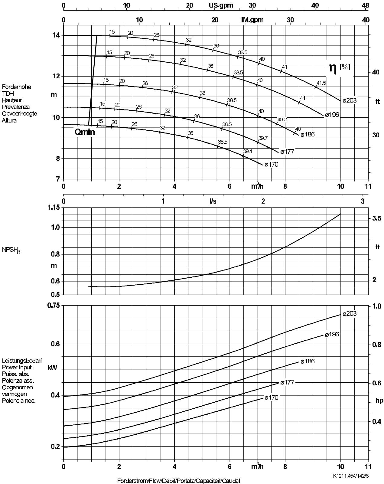
Laufraustrittsbreite/Impeller outlet width/Largeur à la sortie de la roue 6,0 mm
