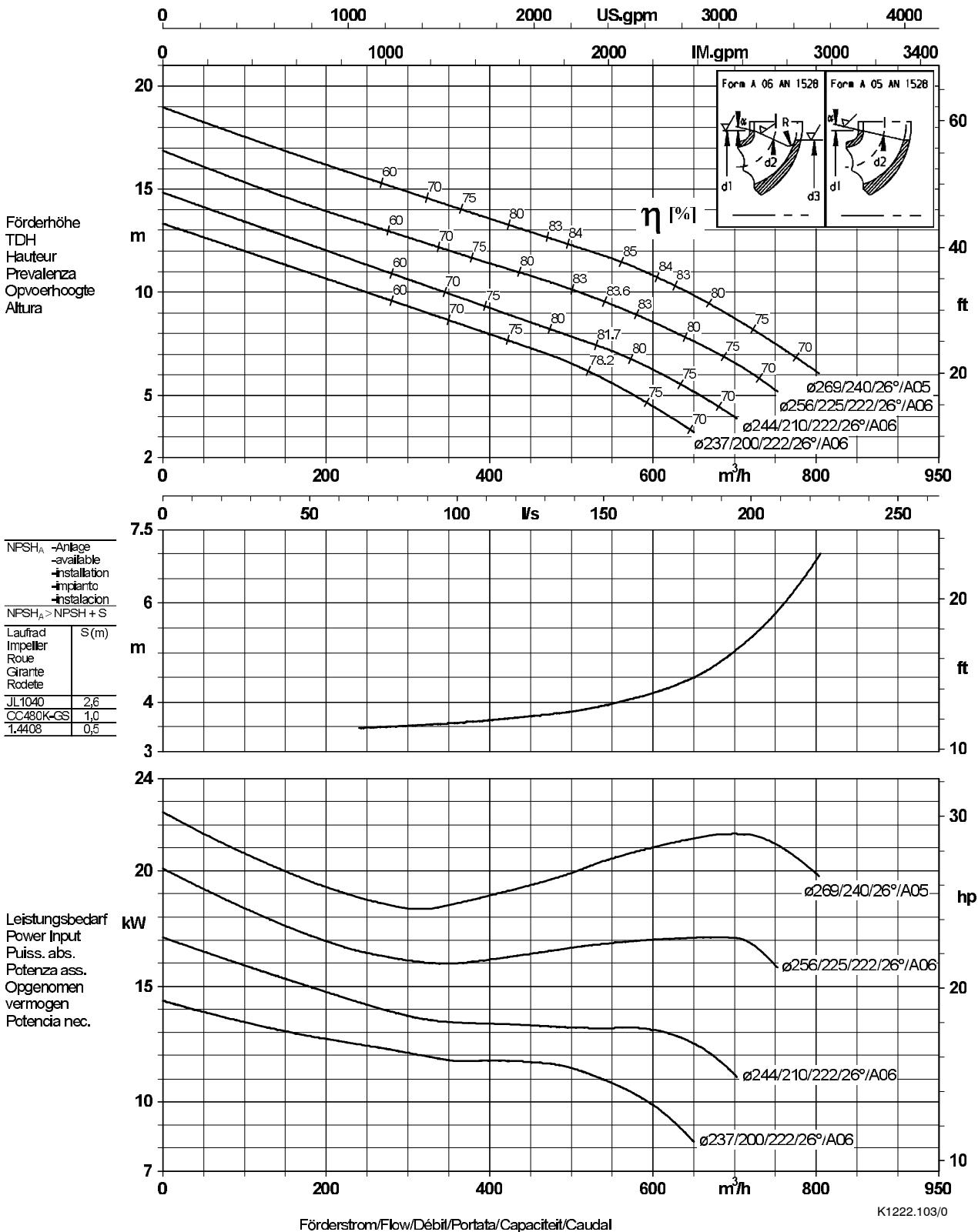
Laufadaustrittsbreite/Impeller outlet width/Largeur à la sortie de la roue 57,0 mm
