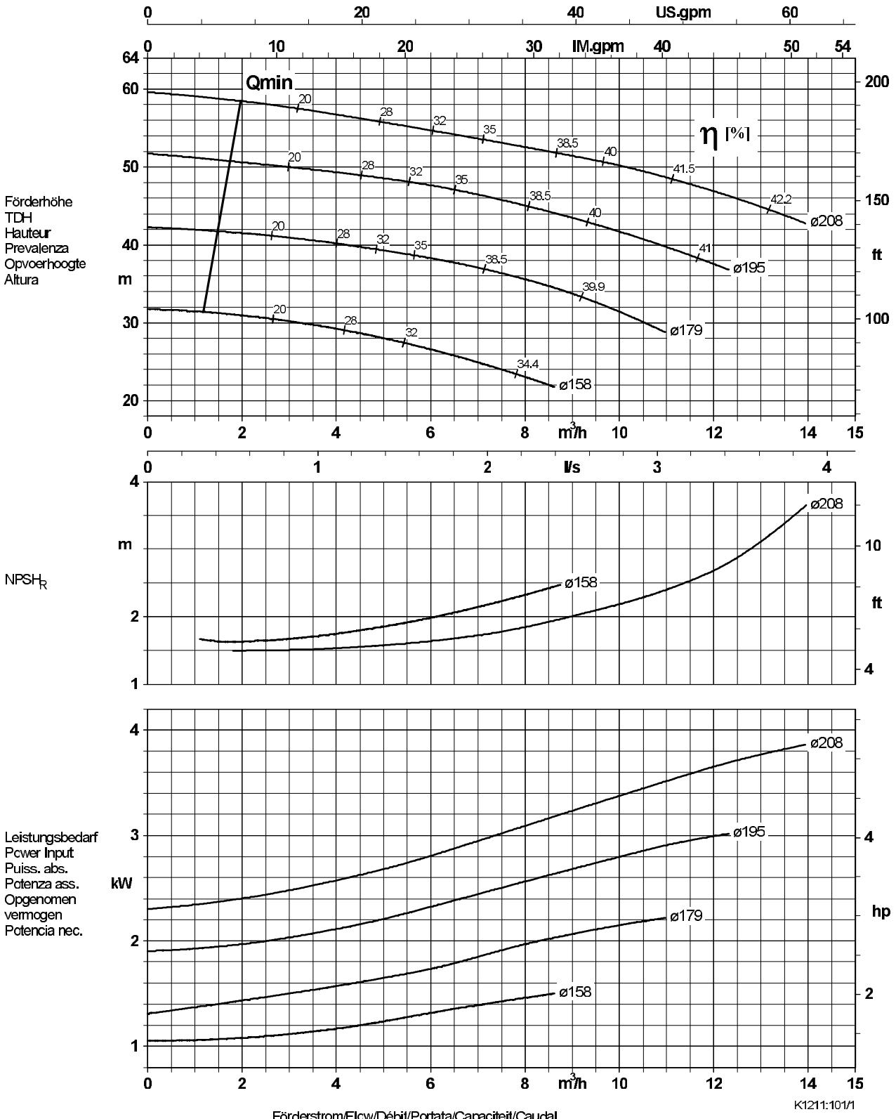
Laufradaustrittsbreite/Impeller outlet width/Largeur à la sortie de la roue 4,0 mm
