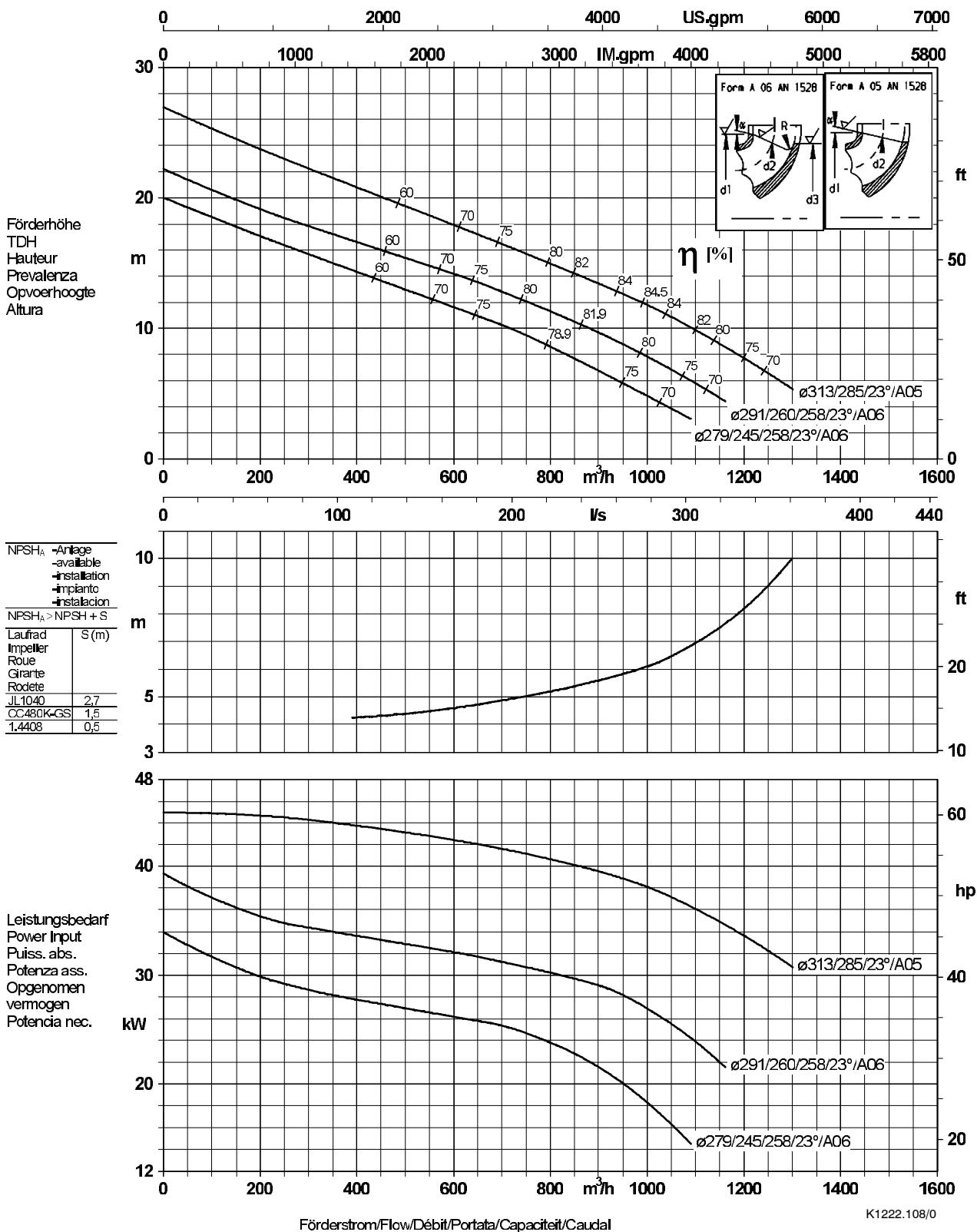
Laufraadaustrittsbreite/Impeller outlet width/Largeur à la sortie de la roue 66,0 mm
