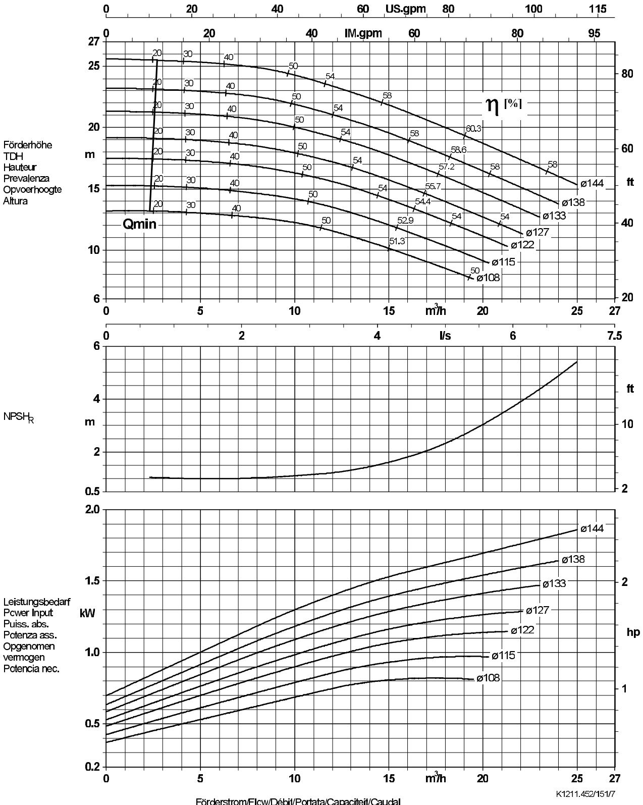
Laufraustrittsbreite / Impeller outlet width / Largeur à la sortie de la roue 5,0 mm
