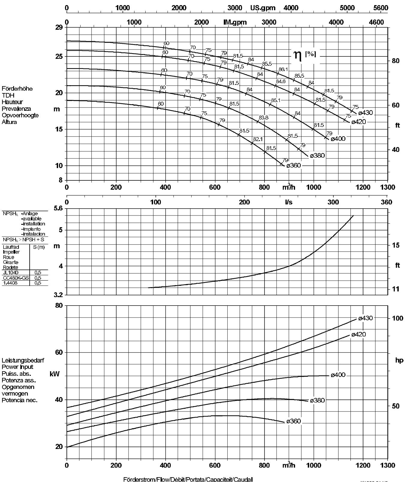
Laufradaustrittsbreite/Impeller outlet width/Largeur à la sortie de la roue 65,0 mm
