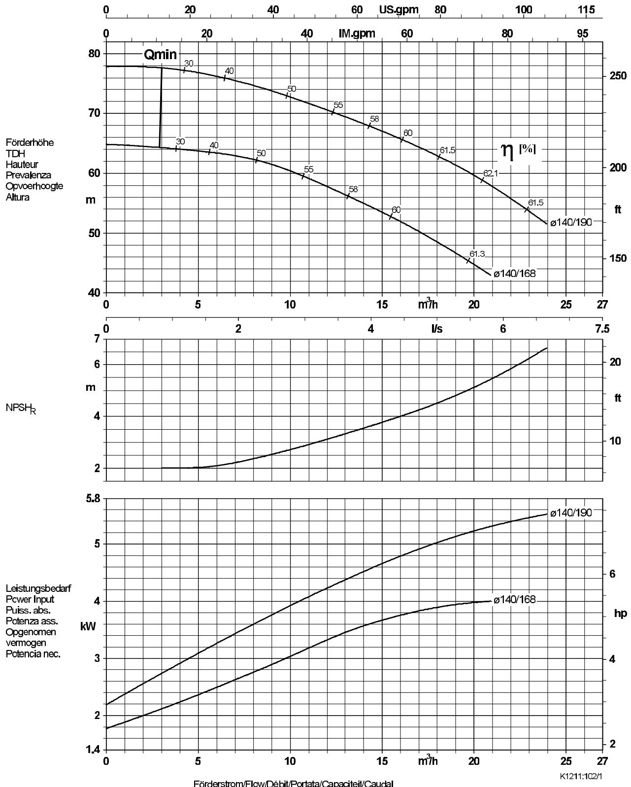
Laufrauadstrittsbreite / Impeller outlet width / Largeur à la sortie de la roue 4,0 mm
