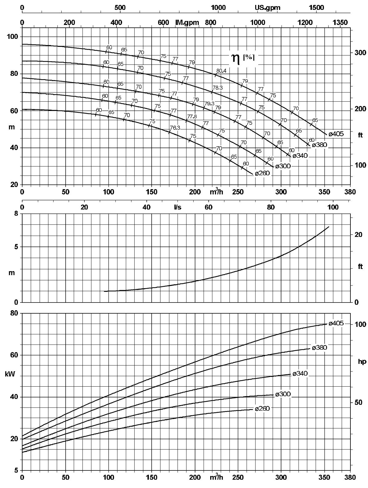
Laufadaustrittsbreite/Impeller outlet width/Largeur à la sortie de la roue 22,0 mm
