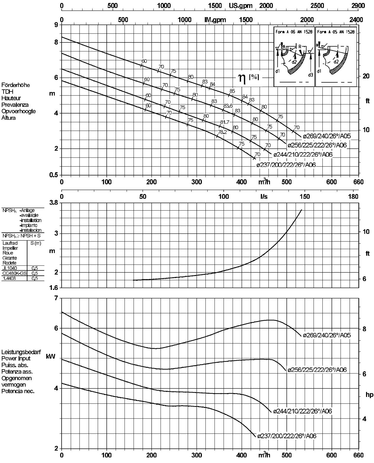
Laufraudaustrittsbreite/Impeller outlet width/Largeur à la sortie de la roue 57,0 mm
