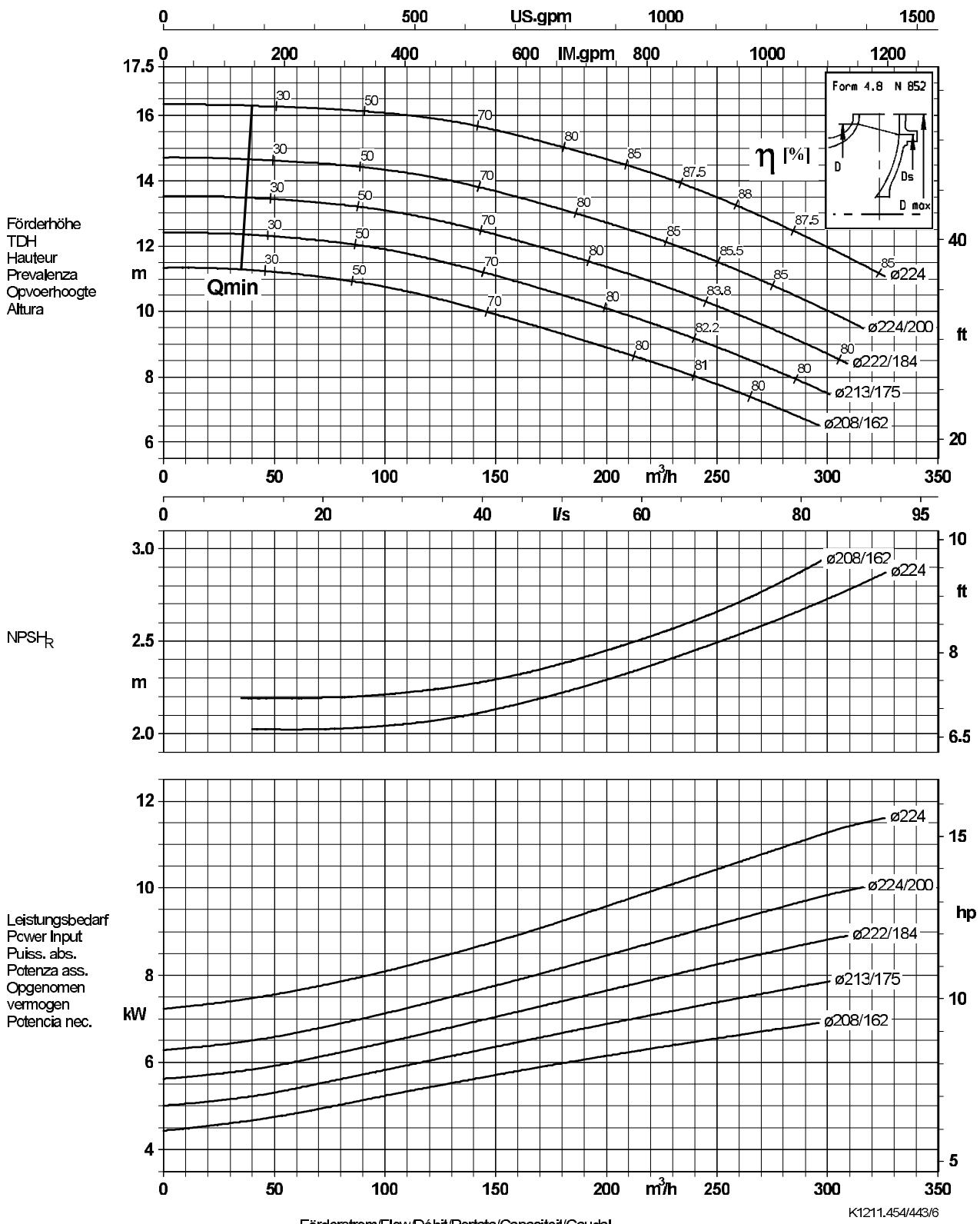
Laufraustrittsbreite/Impeller outlet width/Largeur à la sortie de la roue 40,7 mm
