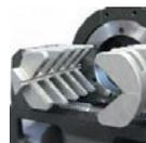
Поворотные зажимные кулачки для обработки тонкостенных и толстостенных труб.
