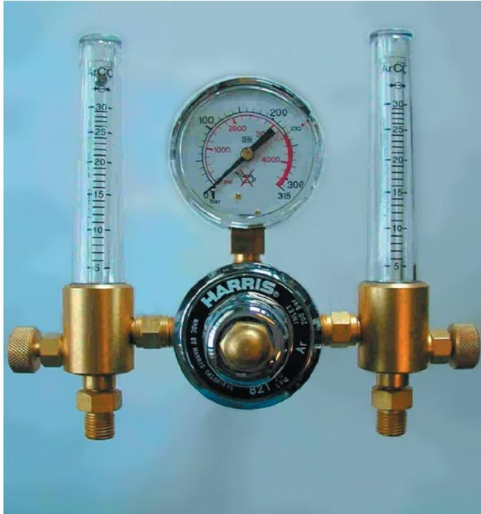
Редуктор предназначен для применения к газовым баллонам для сжатых газов, для ацетилов или для жидких газов.
