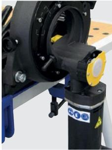
Включая второй зажим пильного полотна для вырезания колен труб
