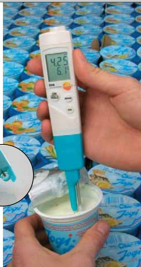
testo 206-pH1: зонд pH со встроенным сенсором температуры.
