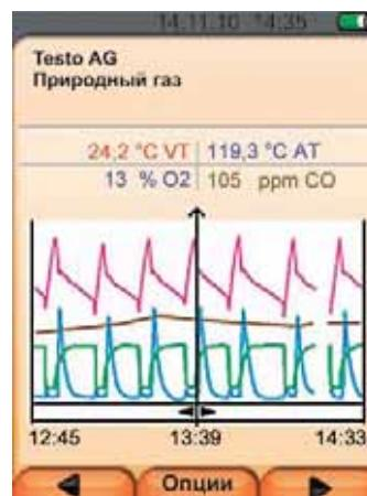
Функция регистратора: измерение и построение графиков для 4-х параметров
