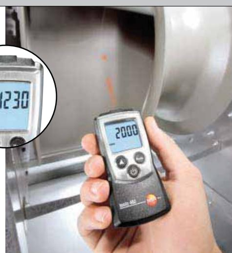
Бесконтактное измерение скорости вращения вентилятора
