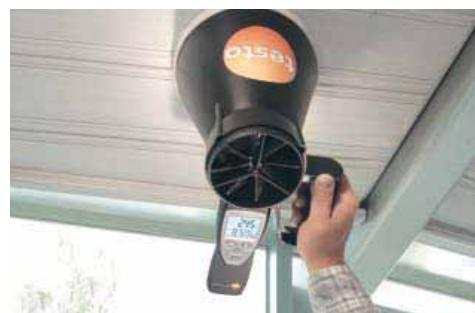
Мониторинг приточной вентиляции на потолочных и тарельчатых диффузорах
