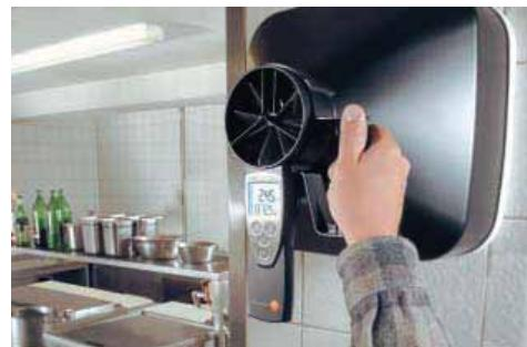
Мониторинг объемного расхода на вытяжном вентиляторе
