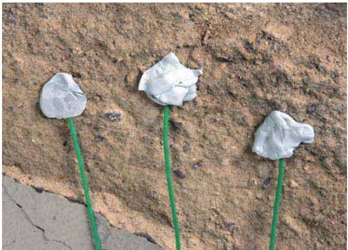
Зонд для определения коэффициента теплопотерь измеряет температуру на внутренней поверхности стены в 3-х точках.
