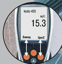
Профили пользователя, задаваемые функциональными кнопками, например, измерения в воздуховодах с возможностью задавать размеры воздуховода для расчета площади сечения и объемного расхода
