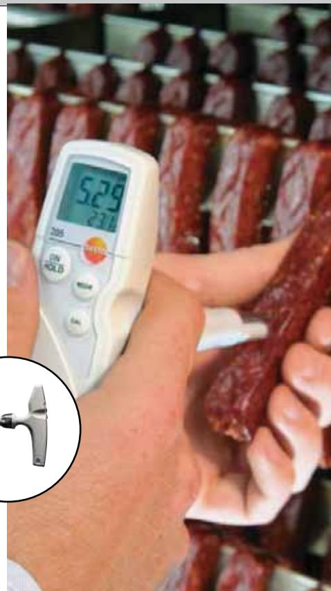
testo 205: прочный зонд для измерения pH и температуры в полутвердых средах.
