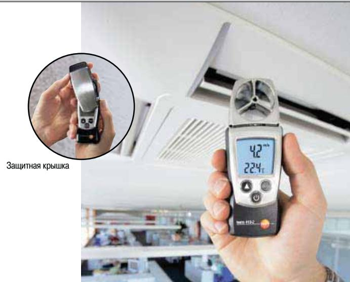
Измерение скорости потока на выходе воздуховода крыльчаткой D 40 мм
