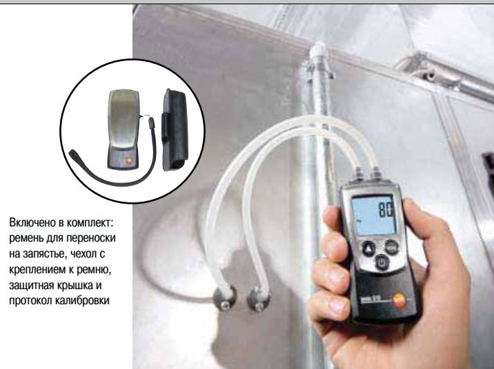
Измерение дифференциального давления на фильтрах
