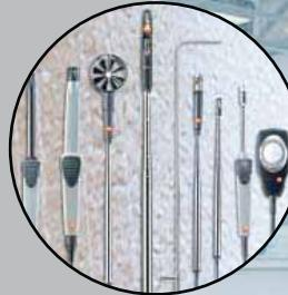
Все параметры важные для настройки систем кондиционирования в одном приборе: м³/ч, м/сек, CO<sub>2</sub>, %OB, °C, гПа, люкс
