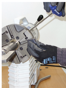
Система быстрого зажима инструмента QTC® (Quick-Tool-Change)
