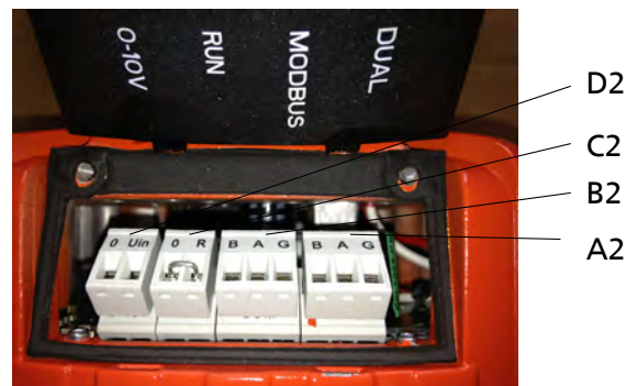
Рис. 7: Отсек для подключения кабелей передачи данных
