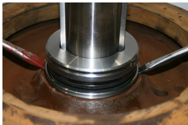
Рис. 10: Извлечение торцевого уплотнения с помощью монтировок
