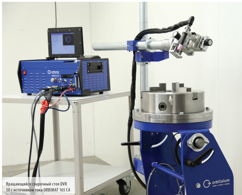
Трехкулачковые патроны для точного позиционирования и фиксации заготовки
