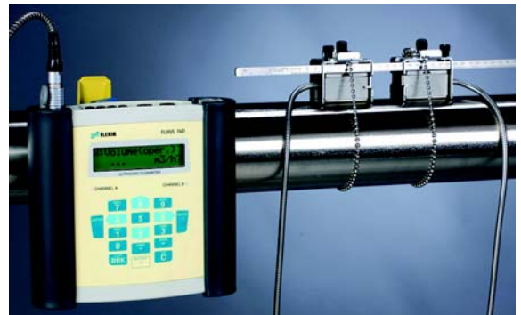
Измерение датчиками, на стальных бегунках с линейкой, и преобразователем расхода, установленным креплением QuickFix
