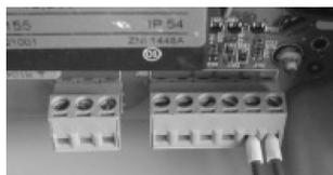
**Рис. 15:** Подключение внешн. тревожной сигнализации
