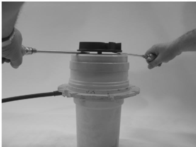
Рис. 30: Снять рабочее колесо
