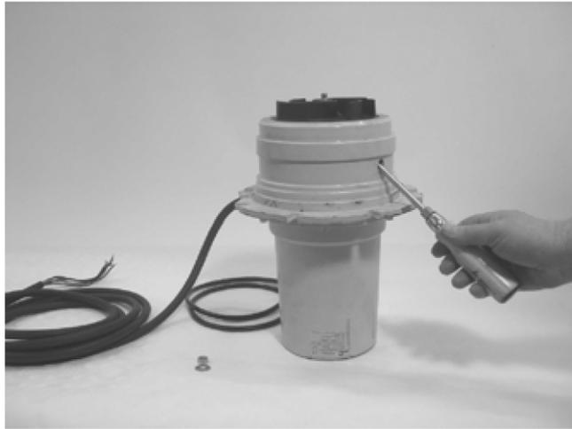
Рис. 29: Ослабить рабочее колесо
